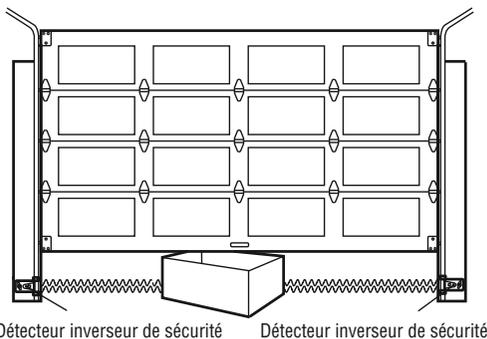
Détecteur inverseur de sécurité      Détecteur inverseur de sécurité
